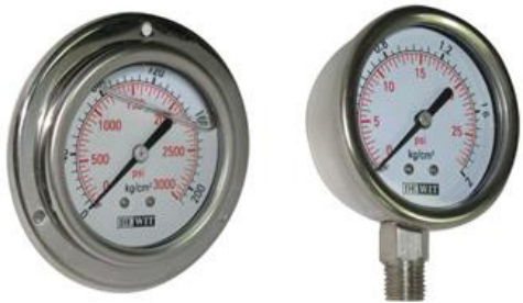
MODELO 2000 SS 2005 SS CAJA DE ACERO INOXIDABLE 304 TAMAÑOS 2 1/2" ( 63mm ) 4" ( 100 mm)
